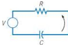
16. Suponha que  $Q(t_1) = Q_L$  e que, no instante  $t = t_1$ , a bateria é removida e o circuito é fechado novamente. Encontre  $Q(t)$  para  $t > t_1$  e esboce seu gráfico.
