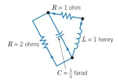
21. Considere o circuito ilustrado na figura abaixo. Use o método esboçado no Problema 19 para mostrar que a corrente I através do indutor e a diferença de tensão V através do capacitor satisfazem o sistema de equações diferenciais
