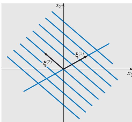
Pontos críticos não isolados;  $r_1 = 0$ ,  $r_2 \neq 0$ .
