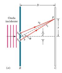
6 A figura (a) mostra a intensidade I em função da posição x na tela de observação para a parte central de uma figura de interferência de dupla fenda. As outras partes da figura mostram diagramas fasoriais das componentes do campo elétrico das ondas que chegam à tela depois de passar pelas duas fendas. Associe três dos pontos numerados da figura (a) aos três diagramas fasoriais das figuras (b), (c) e (d).
