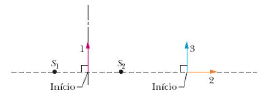
8 A figura abaixo mostra dois raios luminosos, com um comprimento de onda de 600 nm, que são refletidos por duas superfícies de vidro separadas por uma distância de 150 nm. Os raios estão inicialmente em fase. (a) Qual é a diferença entre as distâncias percorridas pelos dois raios? (b) Ao retornarem à região que fica do lado esquerdo das superfícies de vidro, as fases dos dois raios são iguais, opostas, ou nem uma coisa nem outra?
